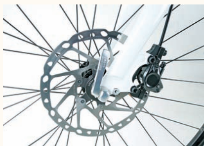
Stehen für geniale Verzögerung: hydraulische Scheibenbremsen am Storck Multiroad: weiches Einbremsen, viel Biss. Unten: Raddar-Aggregat im Heck: überragende Motorcharakteristik, kann rekuperieren.
