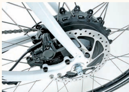
Stehen für geniale Verzögerung: hydraulische Scheibenbremsen am Storck Multiroad: weiches Einbremsen, viel Biss. Unten: Raddar-Aggregat im Heck: überragende Motorcharakteristik, kann rekuperieren.
